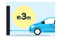
超音波センサーで進行方向の障害物を検知(約3m以内)している場合...
